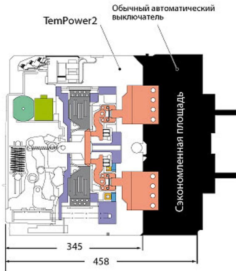
серия мощных стационарных автоматических выключателей на токи от 800 до 6300А, предназначенных для эксплуатации как на промышленных так и на административных объектах. В зависимости от требований возможно изготовление автоматических выключателей предназначенных для эксплуатации в тропическом климате, в условиях агрессивной среды, и других условиях.
